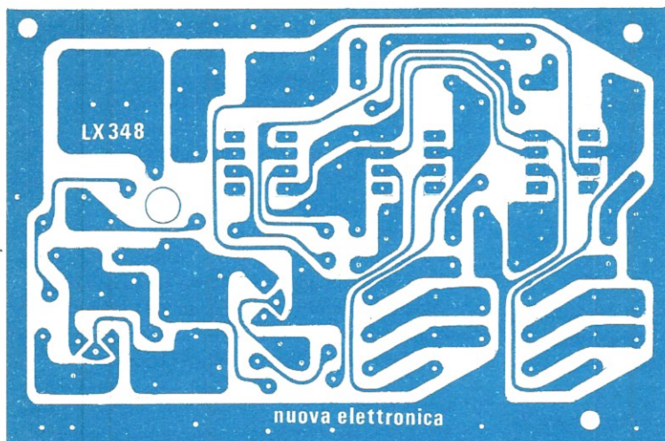
Fig. 2 Disegno a grandezza naturale del circuito stampato necessario per la realizzazione del trasmettitore per radiocomando a 3 canali. Questo circuito, in fibra di vetro, viene fornito già forato e completo di disegno serigrafico dei componenti.
